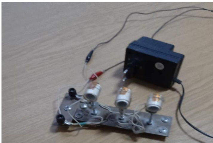
Рис. 6. Установка для одержання трьох кольорів
