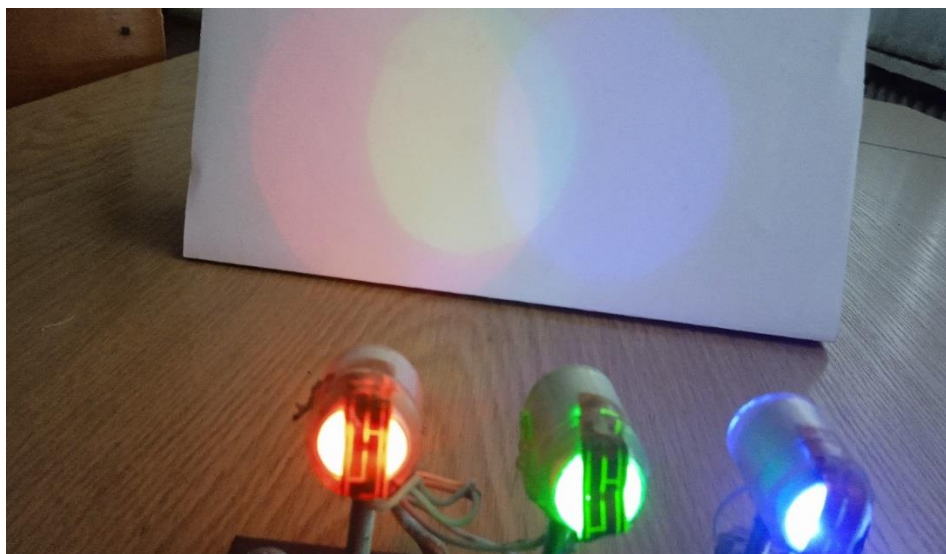
Рис. 8. Одержання білого кольору при змішуванні червоного, зеленого і синього кольорів
