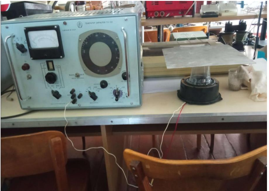
Рис. 1. Фізична установка для спостереження фігур Хладні
