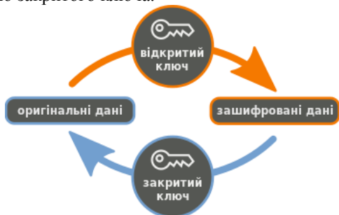
Рис 1. Принцип дії асиметричного шифрування
